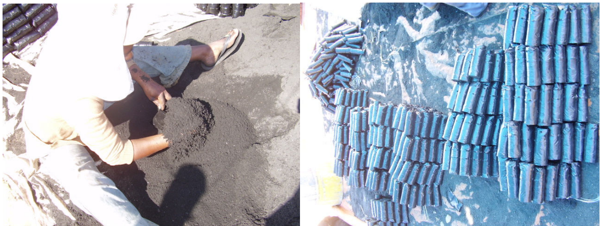
Figura 4 – Envasamento manual de saquinhos com substrato
