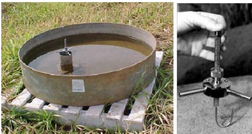
**Figura 4:** Tanque classe A com poço tranquilizador e parafuso micrométrico, em detalhe (HERNANDEZ et al., 2001).
