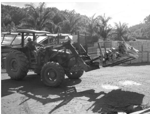
Figura 14. Trator adaptado utilizado no transporte de toras e calços. Fonte: autores.
