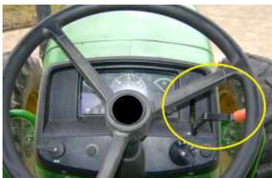
Figura 3. Painel de instrumentos do trator modelo B, com acelerador manual em destaque.
