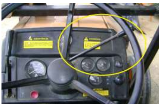
Figura 2. Painel de instrumentos do trator modelo A, com acelerador manual em destaque.
