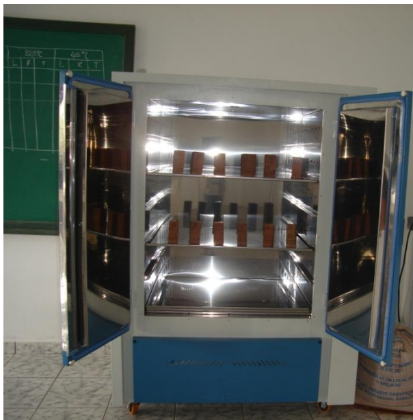
Figura 2- Corpos de prova no interior da estufa.
