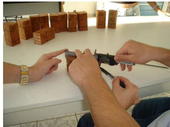
Figura 3 – Medição das dimensões do corpo de prova.
