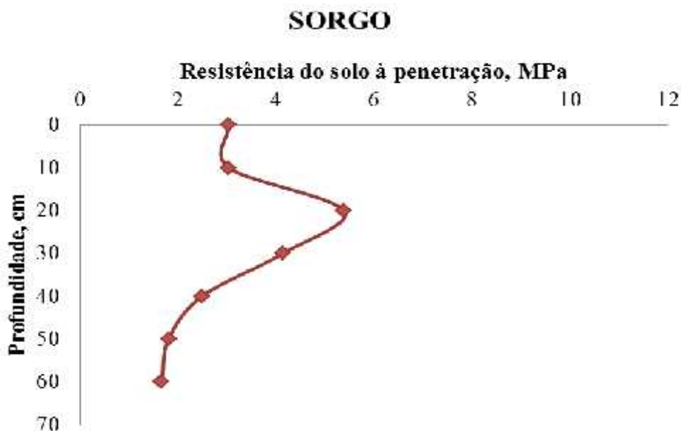
Figura 2. Curva de resistência do solo à penetração em Latossolo Vermelho Amarelo sob cultivo do sorgo. Palmeiras de Goiás, 2014.
