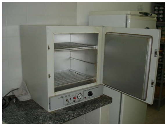
Figura 6. Estufa de esterilização e secagem do laboratório de sementes da FAEF.
