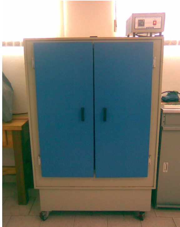
Figura 7. Estufa de esterilização e secagem com fluxo de ar do laboratório de sementes da FAEF.
