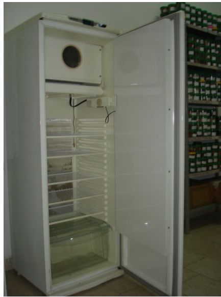
Figura 5. Câmara de germinação tipo BOD do laboratório de sementes da FAEF.
